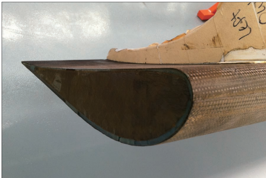
图4 襟翼外形蒙皮与端肋的连接示意图
