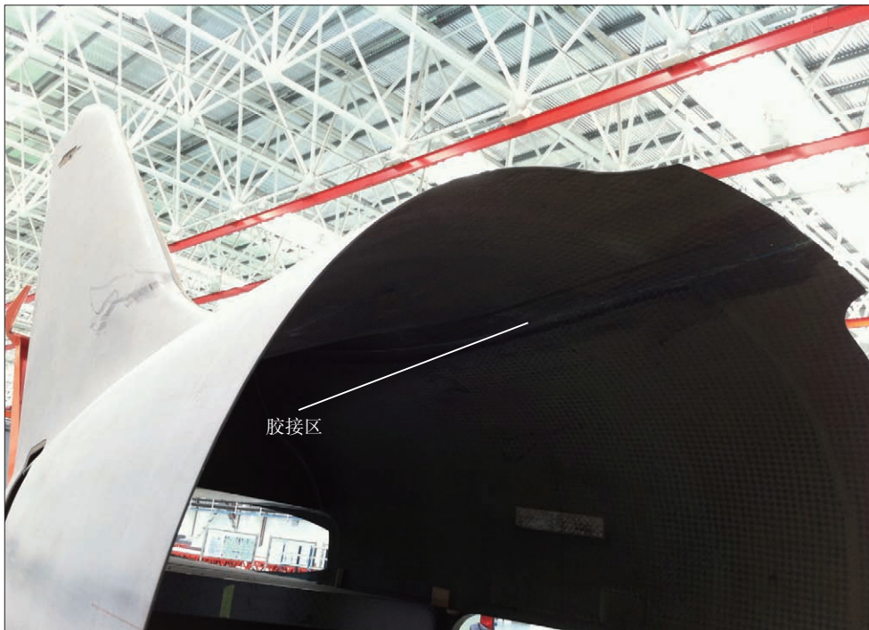
图1 后机身结构胶接示意图
